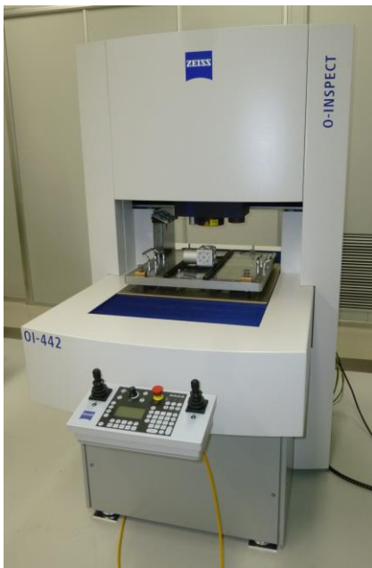
形状測定部 (三次元測定機) Carl Zeiss 社 O-INSPECT442
