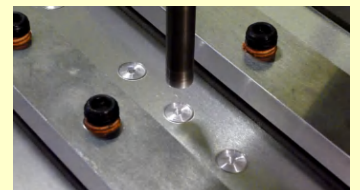
点接合 (FSJ) による重ね継手接合
