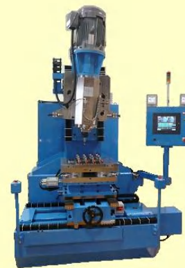
線接合装置 / 1D-FSW 日立設備エンジニアリング製
