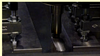
線接合 (FSW) による突合わせ接合
