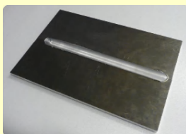
線接合 (FSW) による突合わせ接合
