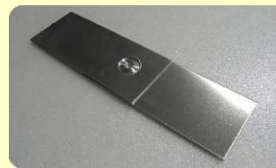
点接合 (FSJ) による重ね継手接合
