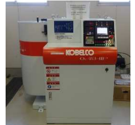
熱間等方加圧装置
