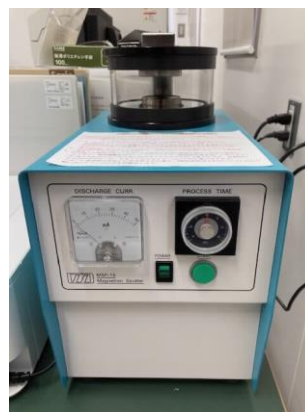
図2 付属装置(マグネトロンスパッタ)の外観
