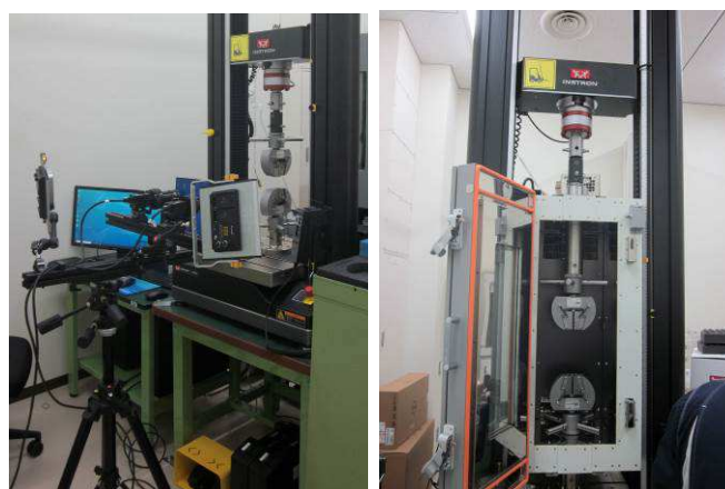
非接触式変位測定（引張） 恒温槽（引張） 図2 測定例
