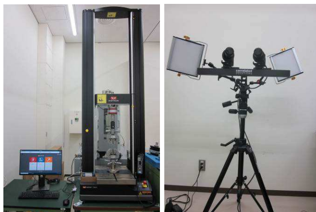
材料強度試験機 非接触式3次元変位測定機 図1 装置外観
