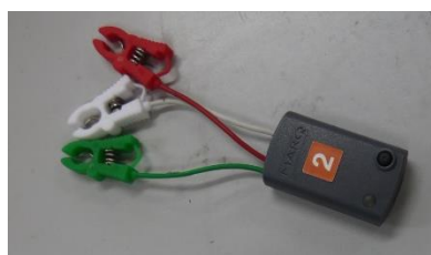
図1 筋電計 MQ-Air (送信機)
