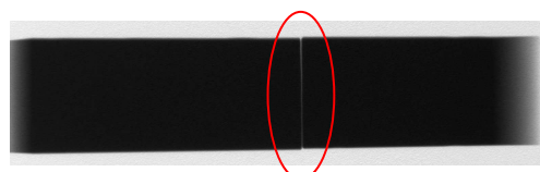
図3 透過像(切断面と透過方向が平行でない)
