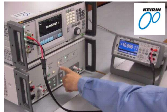
図2 発生部（高精度）によるデジタルマルチメータの校正
