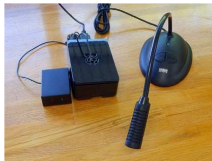
図4 Raspberry Pi 3による試作機
