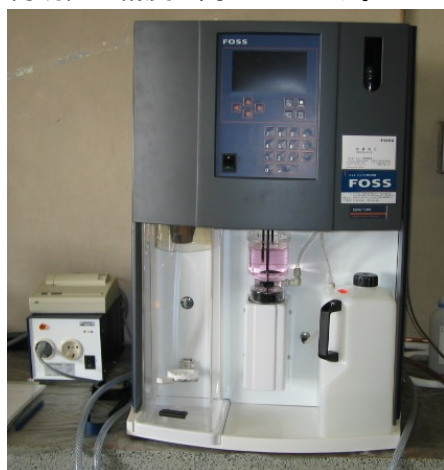
写真1 蒸留装置外観 FT-2300
