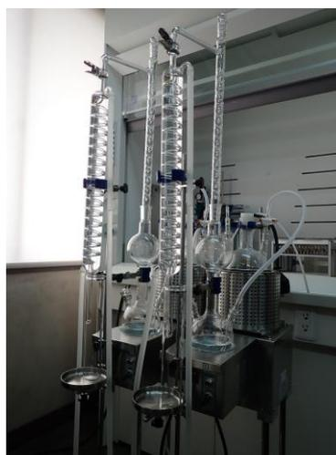
図2 水蒸気蒸留装置外観
