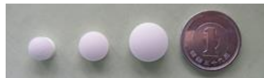
図3 錠剤製造例 左から7mm, 9mm, 12mm, 1円玉(20mm)
