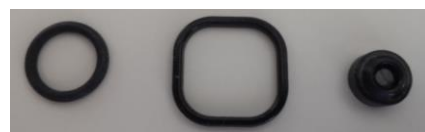
図3 3Dプリンタによる封止部材の製作例
