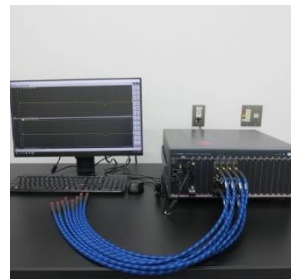
精密・電子・航空技術部門に設置したベクトル・ネットワークアナライザ（キーサイト・テクノロジー製）
