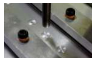
点接合例(重ね継手)
