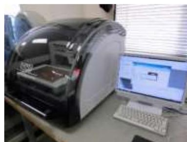
図2 電子回路基板加工装置外観
