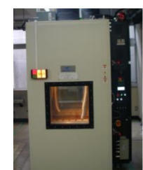
高加速寿命試験機 (HALT) エミック(株) EVTC-4 (精密・電子・航空技術部門)
